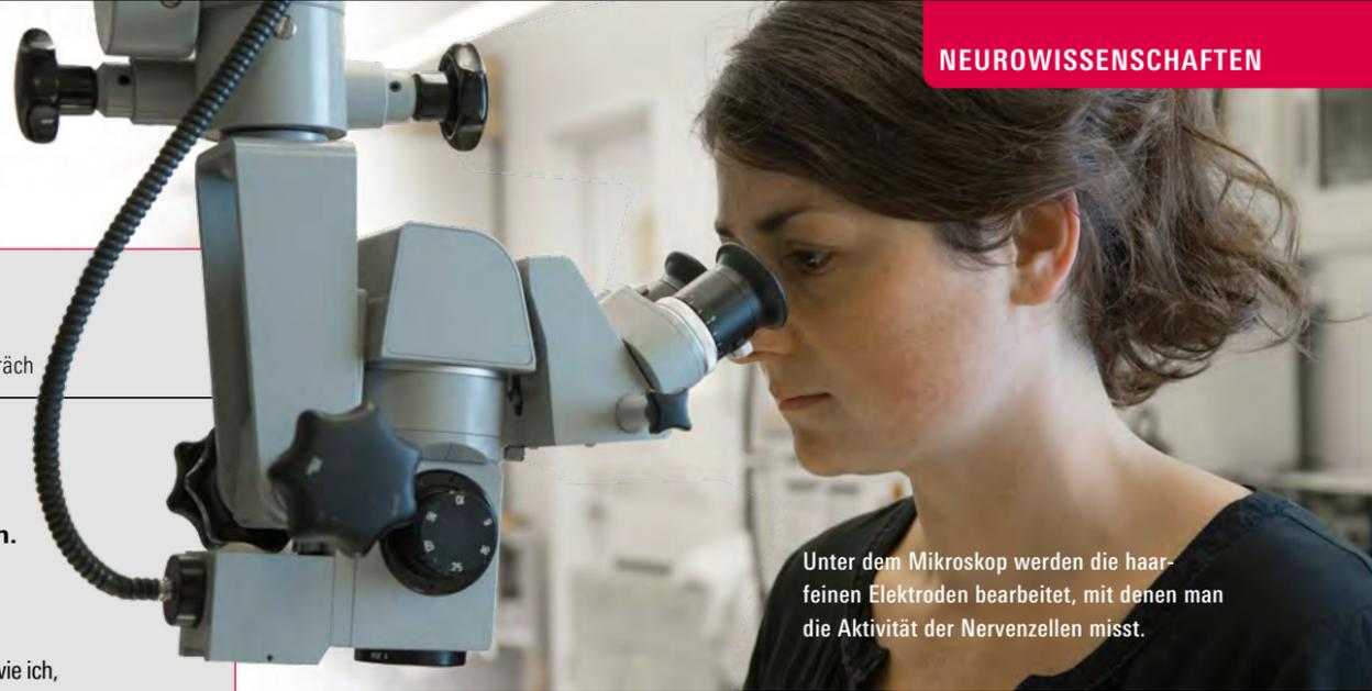
Unter dem Mikroskop werden die haarfeinen Elektroden bearbeitet, mit denen man die Aktivität der Nervenzellen misst.
