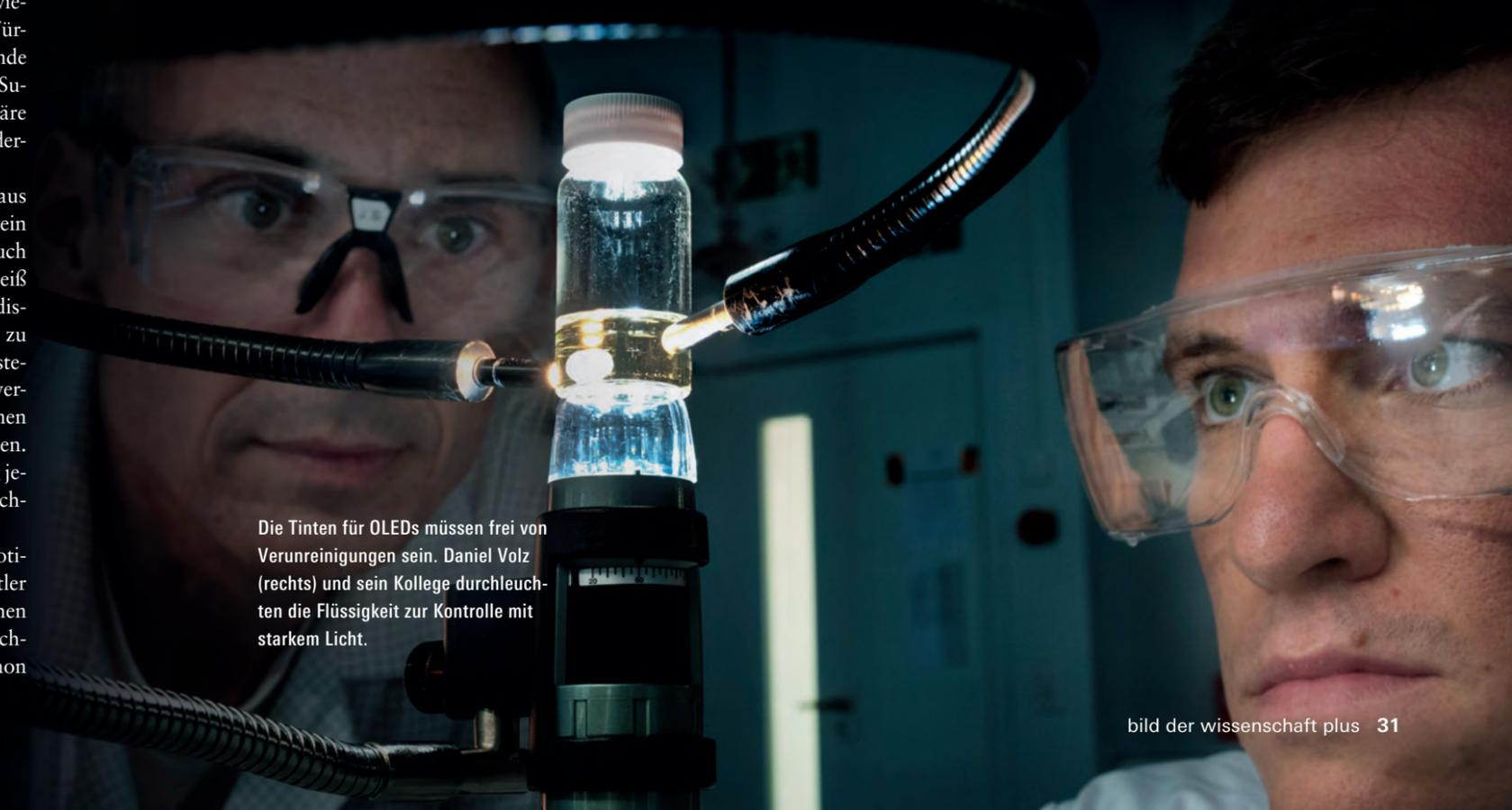
Die Tinten für OLEDs müssen frei von Verunreinigungen sein. Daniel Volz (rechts) und sein Kollege durchleuchten die Flüssigkeit zur Kontrolle mit starkem Licht.
